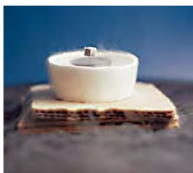
FIGURA 24.12 Un imán permanente levita sobre un superconductor porque su campo magnético no puede penetrar al material superconductor.
