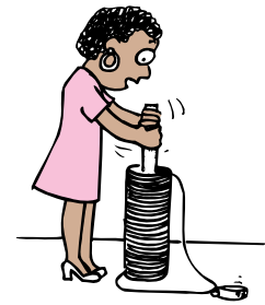
FIGURA 25.4 Es más difícil empujar el imán en una bobina que tiene más espiras porque el campo magnético de cada espira de corriente resiste al movimiento del imán.
